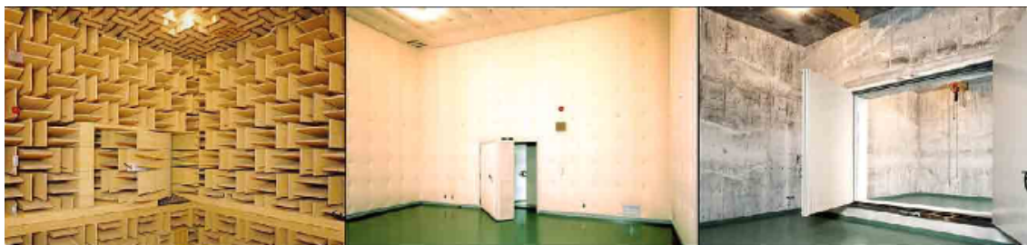
図 11 無響室（左）、半無響室（中央）、残響室（右）の例（(株) 小野測器 HP より引用）
